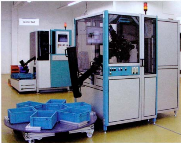
Auf Gleitsystem-, Gesteller-, Lineartakt- sowie Messroboter-Anlagen können eine Vielzahl von Prüfkriterien optisch, taktil, pneumatisch oder mit anderen Methoden auch im Lohn geprüft werden
